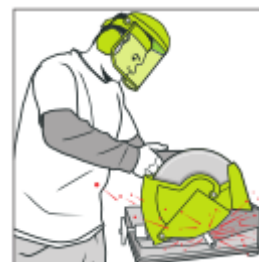
Slika 25: Samonastavljivo varovalo nad rezalnim kolesom se zaniha nazaj, ko rezalno kolo reže jeklo
